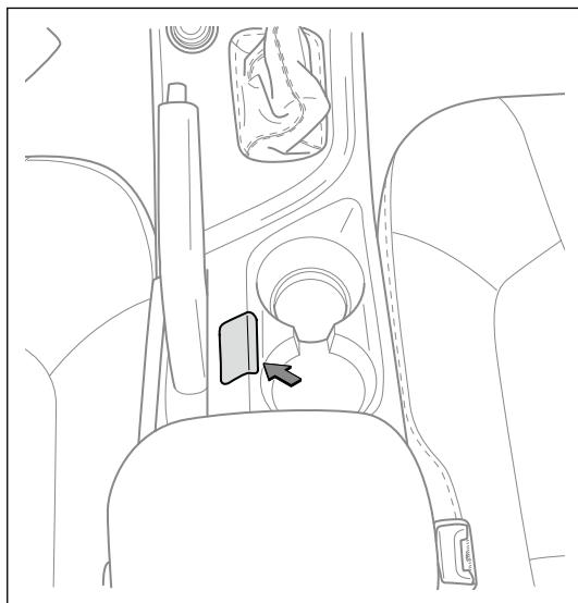
1. 调整驻车制动操纵机构
